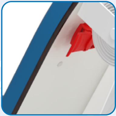
SCHNELLENTRIEGELUNG DER RÜCKENLEHNE ZUR ERLEICHTERUNG DES HLW-MANÖVERS - AUSSTATTUNGSCODE AC8L. AUSSTATTUNGSCODE AC8L
