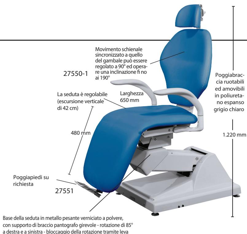
Per piccoli interventi ambulatoriali, movimentata da silenziosi attuatori elettrici azionati da pedaliera a joystick. Dotata di pulsante per tornare nella posizione originale. Rivestimento in skay, imbottitura in gomma indeformabile ad alta densità (50 kg/cm<sup>3</sup>). Seduta e gambale in un pezzo unico. Alimentazione: 230 V - 50 Hz (disponibile 110 V - 60 Hz). Produzione Italiana.
