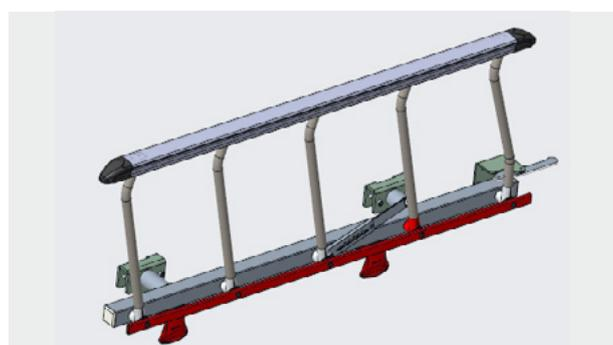
Sponda laterale a compasso con blocco in 5 posizioni intermedie e meccanismo di abbattimento
