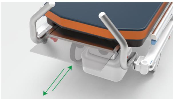
Piano interamente radiotrasparente con inserimento anteroposteriore e scorrimento longitudinale della lastra (canale di introduzione cassetta radiografica con larghezza utile pari a 435 mm).
